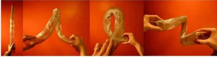
Se busca generar una pieza, autoportante y estructural en si misma a partir de la estratégica disposición de fibras flexibles. Se detecta en el mosquetero de alambre esta potencialidad. Se busca rigidizarlo por forma al enrollarlo sobre si formando un tubo, para aumentar su rigidez se lo refuerza con alambre en las paredes de la pieza a modo de nudos, desde donde puede colgar peso. Se cree que una trama a 45 optimizaría la descargas aumentando la resistencia de la pieza.
