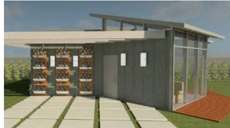
Figura 2: Proposta de Módulo Habitacional Mínimo da equipe de alunos Ellen Andrade, Isabela Tras-si, João Furtado, Juliana Leal e Livia Lacerda. Utilização de estrutura metálica. Projetos (Elétrico, Hidrossanitário e Estrutural) foram modelados para integração e compatibilização.
