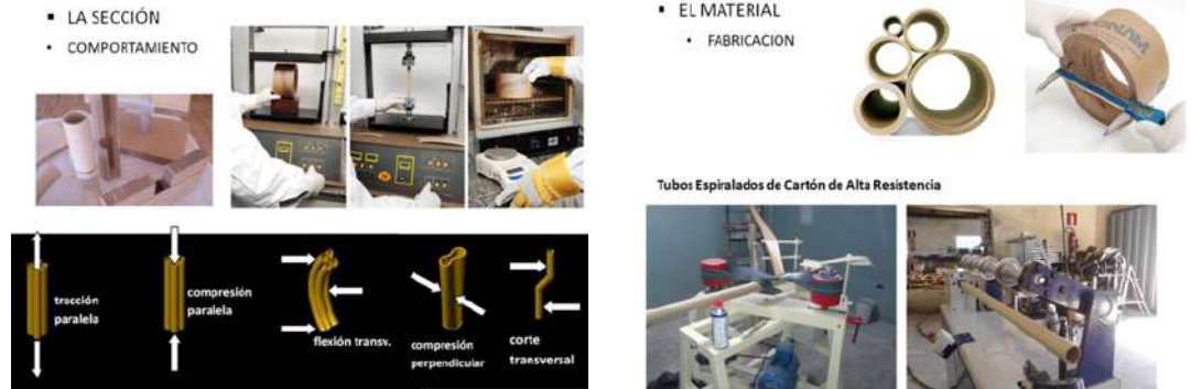
Figura 2. Características de los tubos de cartón. Fabricación y comportamiento.
