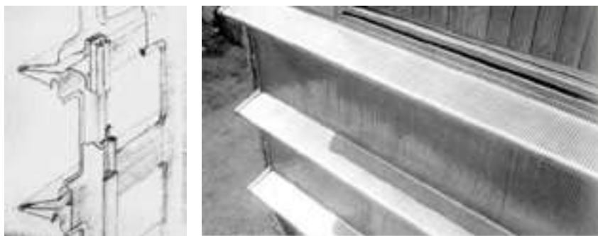
Figura 04: Concepção de um painel de fachada com múltiplas funções.
