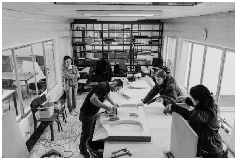
Figura 9: Redução do peso através da retirada de partes internas do relevo e lixamento.
