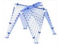
FIGURA 17: detalhe estudo dos esforços na estrutura
